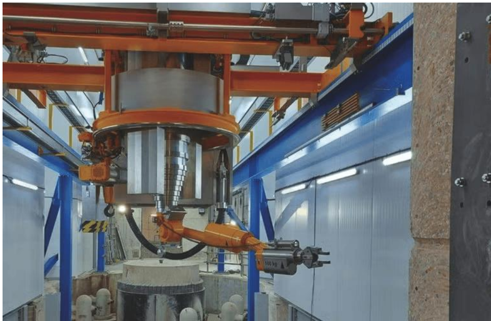
现场退役试验期间的反应堆堆芯分割机
