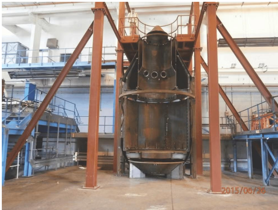
温弗里斯场址的龙核反应堆模拟件
