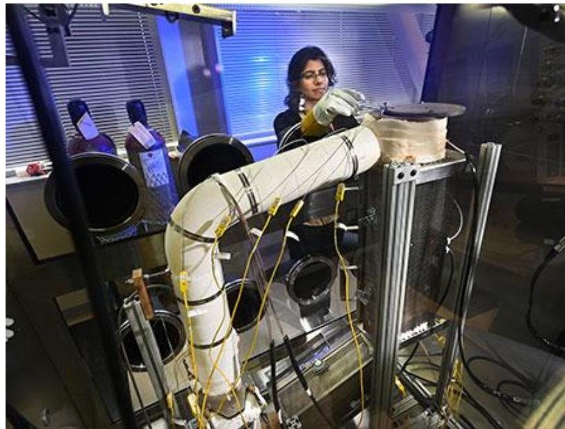
INL研究人员成功完成了熔盐流动回路试验台（Molten Salt Flow Loop Test Bed）的首次运行。该试验台可对氯化物基熔盐技术进行连续、实时的监测与分析。大多数测试回路关注熔盐对结构材料的影响，运行数小时后就必须拆解以分析腐蚀情况。而INL的回路独具特色，它使用可在流动环境中追踪熔盐行为的仪器。这将为更好地理解材料在高温下的腐蚀机理以及传感器性能提供深刻见解。INL是开发熔融氯化物反应堆实验（MC RE）团队的一员，该实验将展示世界上首个运行的快谱熔盐反应堆。
