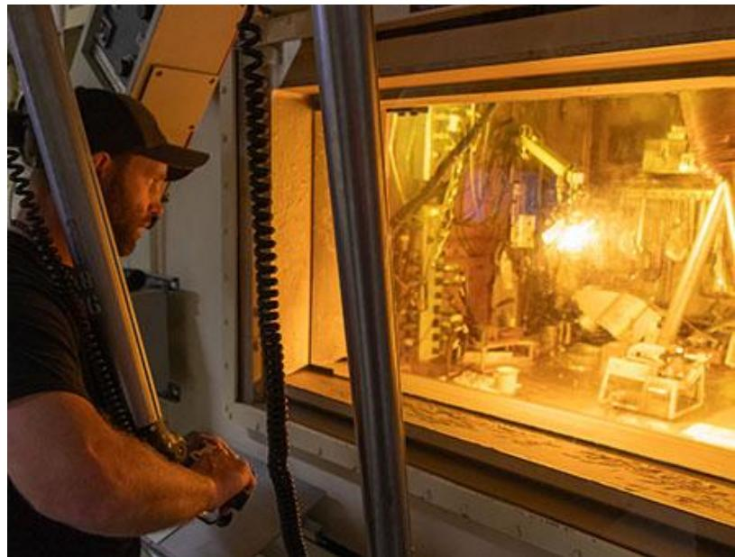
INL 及其先进试验堆（ATR）为 CCThE（Clean Core Thorium Energy）公司验证其富集寿命先进核能（Advanced Nuclear Energy for Enriched Life，ANEEL）燃料提供了保障。ANEEL是一种用于重水加压反应堆（PHWR）的新型核燃料设计，有望减少废物、提升安全性并降低成本。2024年春季，工程师们将216颗ANEEL燃料芯块放入ATR堆芯进行辐照；2025年，第一批芯块被取出并送至热室燃料检验设施（Hot Fuel Examination Facility，HFEF）进行辐照后检验。第二批检验将于2026年进行。
