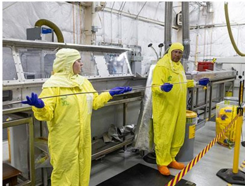
材料与燃料综合设施（MFC）的工程师们在INL的实验燃料设施（Experimental Fuels Facility, EFF）中，利用共挤压（co-extrusion）技术，生产出一根长段的锆包壳浓缩铀棒。这项工作是为Lightbridge公司完成的，这些样品是该公司计划用于其商用燃料产品的合金模型，旨在提升核电站的效率与性能。共挤压是一种制造工艺，可将两种或多种不同材料同时通过一个模具挤出，形成具有多层结构的复合产品。工程师们使用EFF的挤压机，共挤压出一根长约8英尺的细圆柱形棒材，该棒材将被切割成小段，并在INL的先进试验堆（ATR）中进行辐照。
