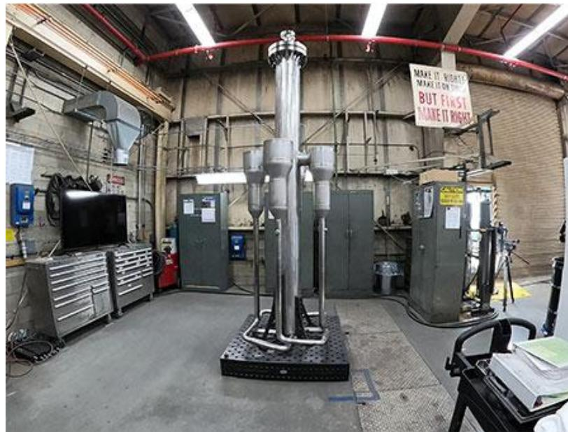
INL的研究团队使用独一无二的主冷却剂装置试验台（Primary Coolant Apparatus Test，PCAT），对微型反应堆应用研究验证（Microreactor Applications Research Validation，MARVEL）项目的部件进行了严格验证。PCAT几乎是MARVEL反应堆主冷却回路的精确模型，它使用电力而非核能产生热量，以复现其热工水力行为。通过分析建模和数值模拟，该团队证明了MARVEL的冷却方案是可行的。此项测试对于验证设计并确保微型反应堆在现实环境中安全有效运行至关重要。
